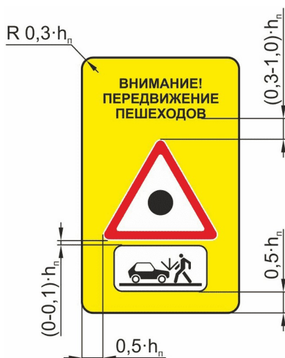
Рисунок В.11 - Пример компоновки изображений знаков стандартной формы, расположенных на фоне щите желтого цвета
